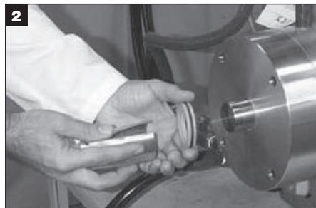
Ein 0,127 mm dickes Messingblech auf eine Länge zuschneiden, die ca. 6 mm größer als der Wellenumfang ist. Das Blech rollen und in die Dichtung schieben.
