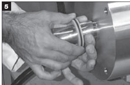
Ein Ende auf die Welle aufschieben, indem der aus dem Blech geformte Zylinder über dem Wellenende aufgeweitet wird.
