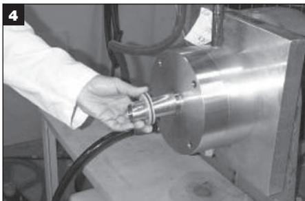
Das Ende des Zylinders, das aus dem Blech geformt wurde, auf das Wellenende ausrichten.
