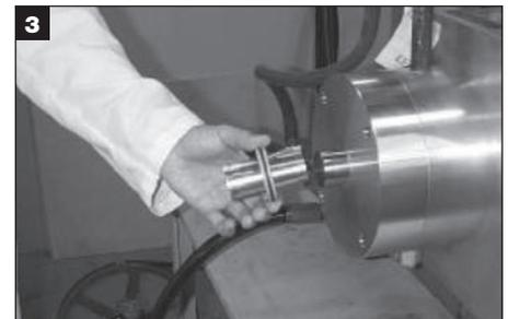
Das Blech drehend durch die Dichtung durchführen.
